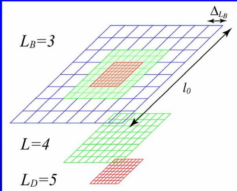
計算格子は階層構造を形成している。
